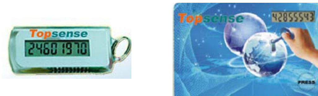
图 2.1 动态口令卡（动态口令生成器）硬件
